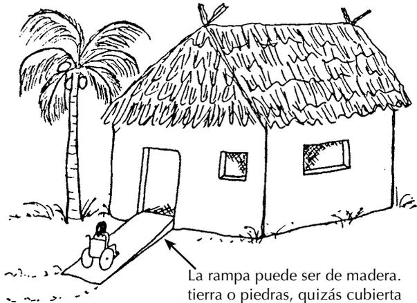
La rampa puede ser de madera, tierra o piedras, quizás cubierta con una capa delgada de cemento. (Vea detalles en la pág. 489.)
