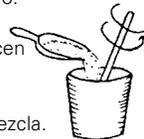
4. Rápidamente vacíela en el molde. Mueva la varilla de lado a lado y dele golpecitos al molde, para que la mezcla llene todos los huecos.
