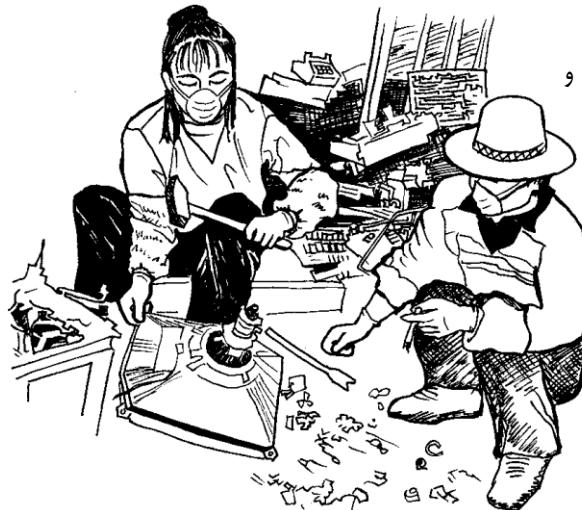
ساخت وسایل برقی مثل: کمپیوترها، تلویزیونها، موبایل ها و رادیو ها به منابع فوق العاده ای نیاز دارد. این وسایل در ترکیب خود مواد توکسیک زیادی دارند. مانند: کدمیوم، سرب، باریوم، سیماب، شعله خاموش کن ها (صفحه 372)، و پلاستیک های PVC (341).
