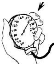
سوزن ساعت شروع به عقب آمدن میکند (اگر والو بسته باشد در بالای 200 باقی خواهد ماند.
