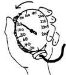
در هنگام پمپ نمودن سوزن ساعت به حرکت شروع مینماید زمانیکه سوزن به درجه 200 رسید، پمپ کردن را توقف دهید.
