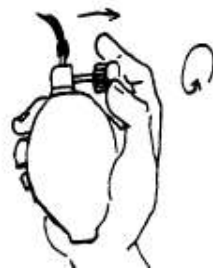
بعد به آهستگی والو را باز نمایند که هوا به آهستگی خارج شود.
