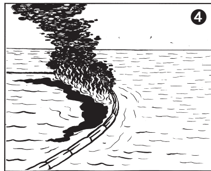
Setelah sebanyak mungkin minyak disendok, diserap, dan disingkirkan dari permukaan, maka sisanya akan siap untuk dibakar. Membakar minyak yang tersisa tersebut akan menghasilkan asap beracun, tetapi masih lebih baik dari pada meninggalkannya di air.
