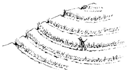
土の流出を防ぐために山腹に溝をめぐらせる
