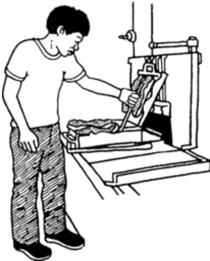
برای کار با مواد داغ از ابزار استفاده کنید
