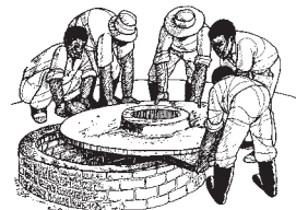
Beton örtügi guýynyň agzyna goýuň.
