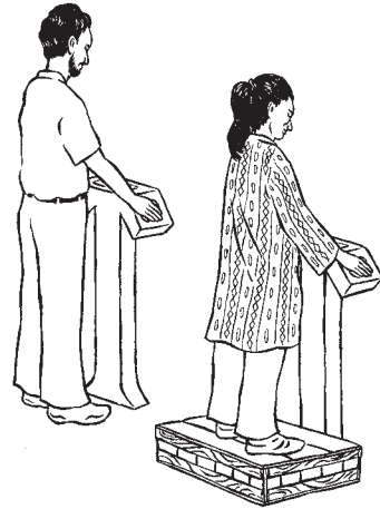
Bậc đứng thuận tiện cho người có chiều cao thấp để điều khiển các công tắc, cần gạt và tay cầm.
