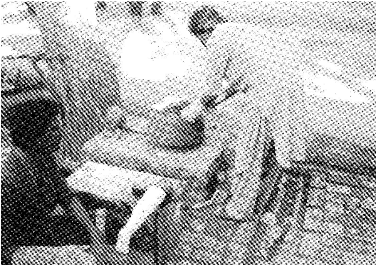
Пешаварда (Пакистан), коомчолук реабилитациялык өнүктүрүү программасында эмгектен жумушчулар автобустун пластик терезелеринен бут үчүн ортездерди жасашат. Сүрөттө жумушчу тышта кыштан жасалган мештин үстүндө пластикти ысытып жаткан кези көрсөтүлгөн.
