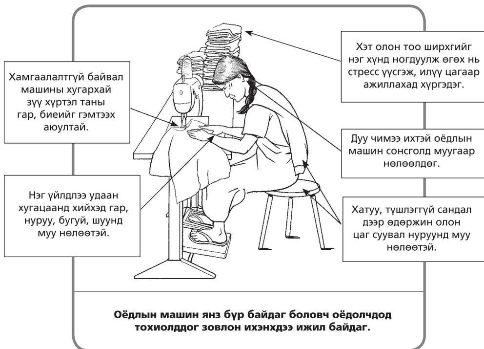
**Оёдлын машинаас болж үүсэх гэмтэл:** Оёдлын машины зүү таны гар хурууг эсгэж, гэмтээгээд зогсохгүй нүд рүү ч үсэрч орох аюултай. Хувцасны хэсгүүдийг нийлүүлж оёж байхад үс зулгаагдаж оёгдох, бүр цаашилбал бүхэл биеийг машин руу татан оруулах аюултай.
