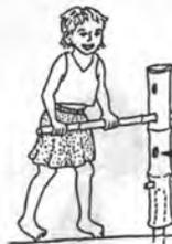
Отверстия для рукоятки, позволяющие регулировать высоту крепления.
