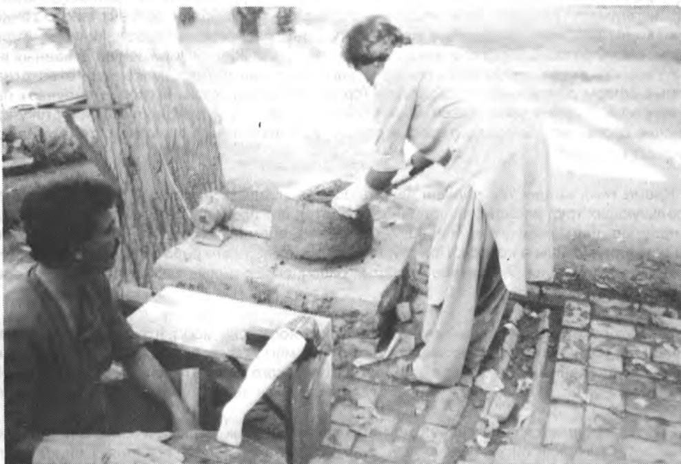
В Пешаваре (Пакистан) участники проекта развития общественных программ реабилитации делают ортопедические аппараты из пластмассовых автобусных окон. Здесь показано, как рабочий разогревает пластмассу.
