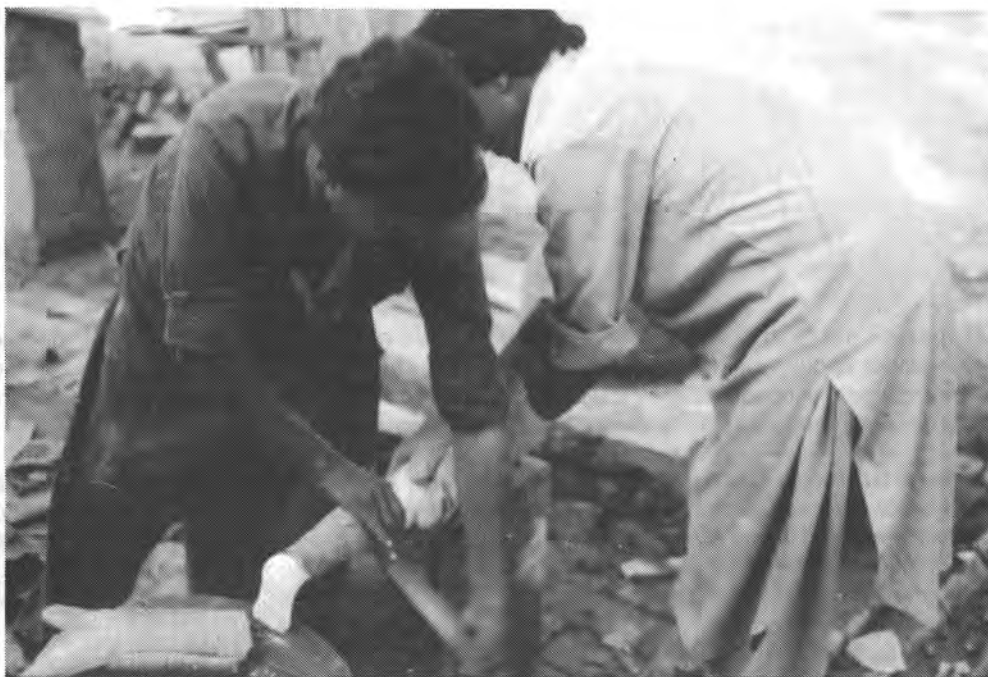
Когда пластмасса размягчится, рабочие накладывают ее на болванку. Затем плотно обматывают резиновыми лентами и оставляют в таком положении до затвердевания.
