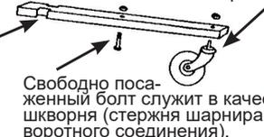
Свободно посаженный болт служит в качестве шкворня (стержня шарнира поворотного соединения).
